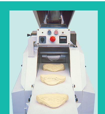
Pasta espulsa sul nastro trasportatore dopo la spezzatura veloce e naturale.
