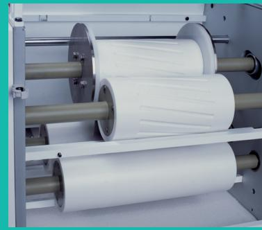
Quattro cilindri regolabili di laminazione
