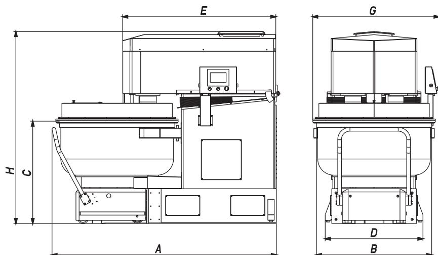
Besonders leistungsstarker Doppelspiralkneter für den industriellen Einsatz. Für die rasche, gleichmäßige und schonende Verarbeitung aller Teigarten. Durch die intensive Aktion der Doppelspirale wird mehr Wasser im Teig eingearbeitet ohne die Teigstruktur zu verändern, auf diese Weise wird der Mehlbedarf wesentlich eingeschränkt.
