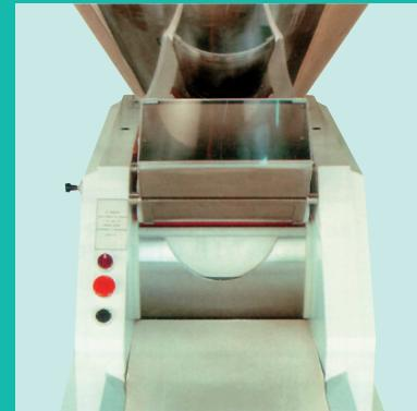
Nastro trasportatore temporizzato e pistone con posizionamento automatico a fine ciclo.
