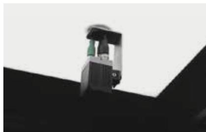
*Telecamera ad alta precisione, in grado di identificare il baricentro di pezzi di impasto in movimento*
