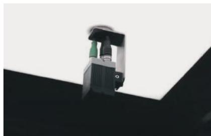
*Cámara de alta precisión, capaz de identificar el centro de gravedad de las piezas de masa en movimiento*
